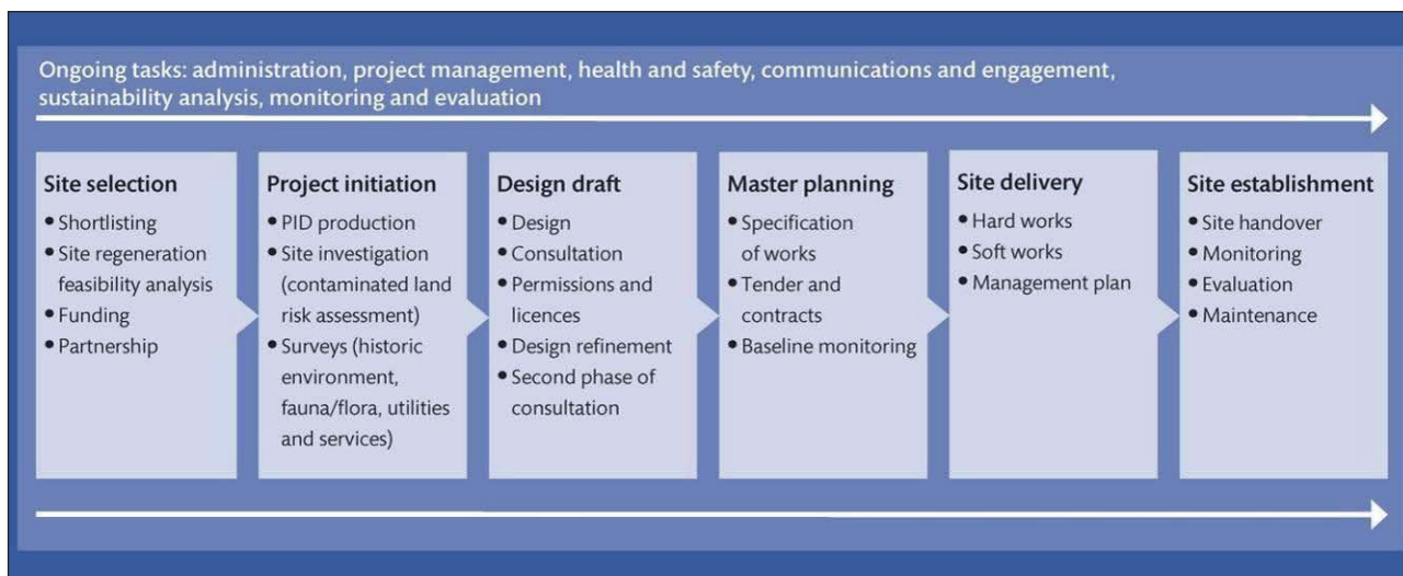
Fig. 6.1. Fasi e attività per la realizzazione del progetto di infrastruttura verde [Atkinson, Doick, 2014]
