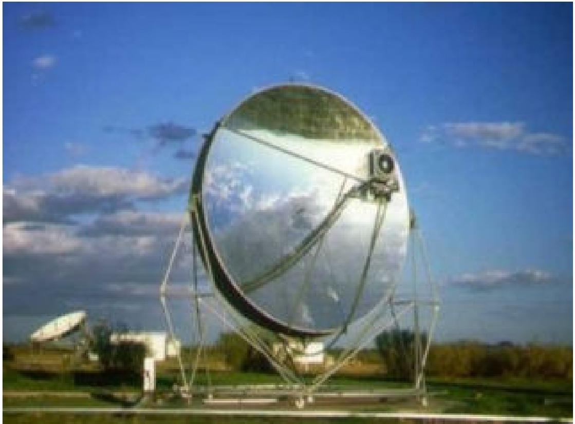
*Fig. 23 – Disco parabolico solare*
